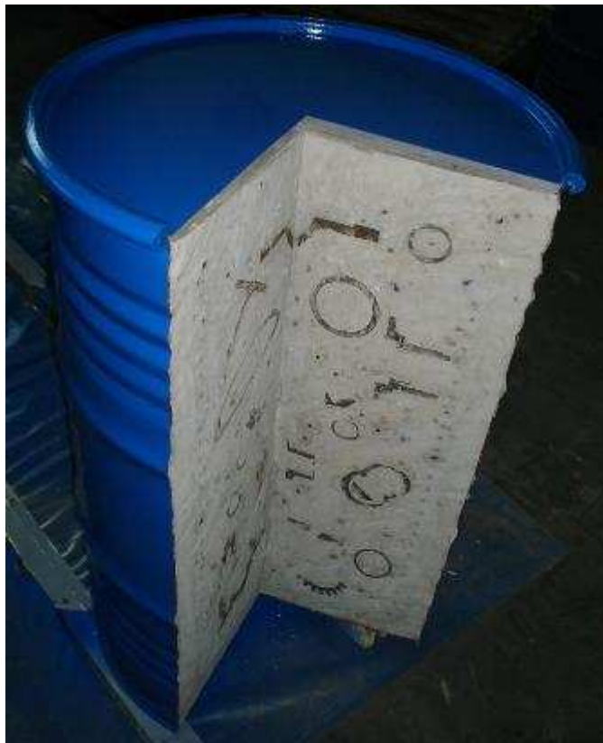
Sectiune in butoi cu deseuri conditionate
